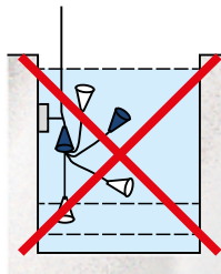
Imagen 6. Evite una sujeción en la que el cable podría doblarse por una curva demasiado pronunciada.
